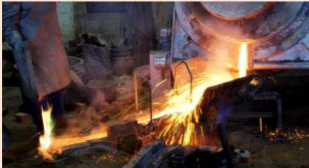
Schmelzofen werden dann Kanäle zu den einzelnen Glockenformen gelegt. Am Tag des Glockengusses wird durch die Kanäle flüssiges Metall, die Bronze, geleitet. Sie füllt den Zwischenraum zwischen Mantel und Glockenkern.
